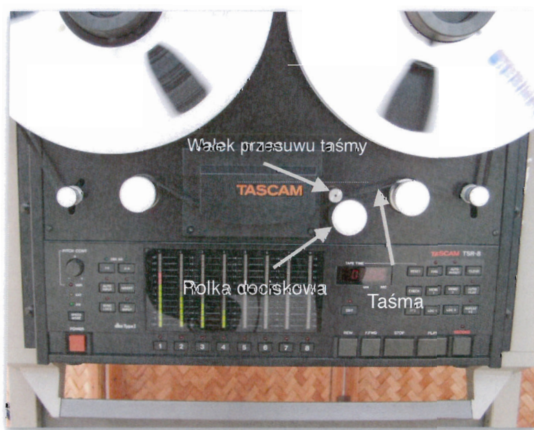
Rys. 8. Klasyczna metoda przesuwu taśmy w magnetofonach
